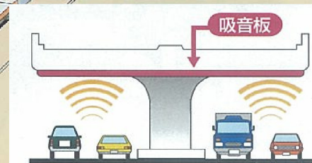
高架裏面吸音板
